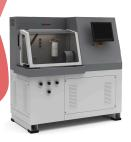
COMMON RAIL PUMP TEST BENCH TK1035
