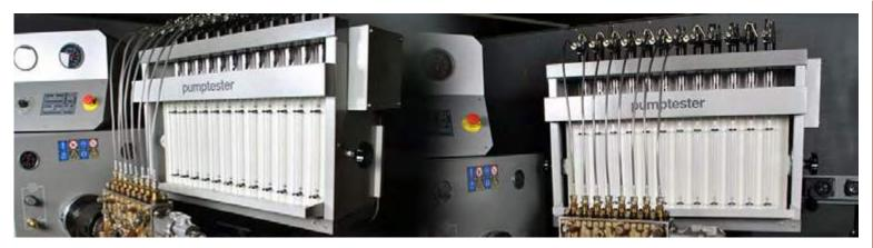
**12 CYLINDER GLASS TUBE MEASUREMENT SYSTEM**
